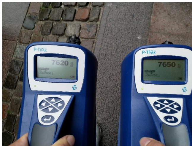
Billede 2 Viser henholdsvis Miljøpunkt Nørrebros og Miljøpunkt Indre bys måleapparat der måler parallelt. Målerne målte ens med en ubetydeligt lille forskel. (Eget billede, 2018)
